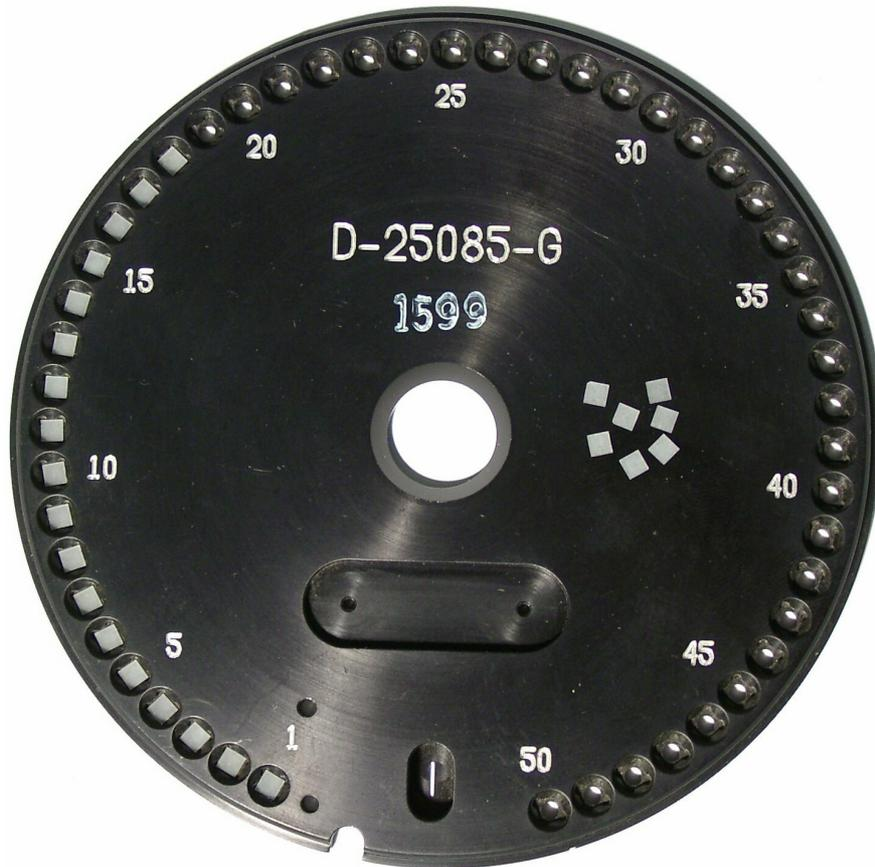
Das Schubfach ist dann bis zum Anschlag herauszuziehen und der entsprechende Teller auf den Dorn zu stecken. Dabei ist zu beachten, dass der Mitnehmerstift der gerätefesten Trägerplatte in der Nut des Tellers sitzt. Ansonsten ist der Teller so lange zu drehen, bis der Stift einrastet.
